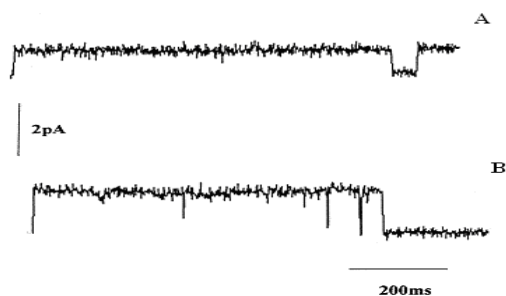
Fig. 3. Record showing two types (A, B) of amphotericin B channels in a lecithin bilayer. Transmembrane potential 100 mV. A - AmB concentration 5 \times 10^{-6} M; B - AmB concentration 8 \times 10^{-4} M.
