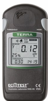
Fig. 1. “Terra” dosimeter-radiometer MKS – 05
